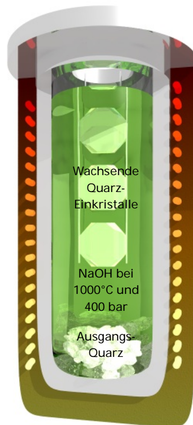
Abb. 28: Die Zucht von Quarz-Einkristallen nach dem Hydrothermal-Prinzip
