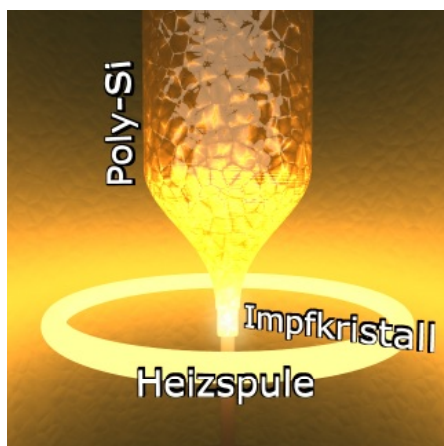
Abb. 5: Beim Zonenschmelzverfahren schmilzt eine Induktionsspule einen polykristallinen Silicium-Kristall der Länge nach auf, welcher dahinter beim Abkühlen einkristallin erstarrt.
