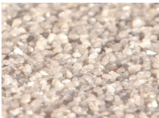
Abb. 2: Quarzsand (oben) wird mit Graphit in Schmelz-Reduktionsöfen (rechts: Schema eines Lichtbogenofens) zu Rohsilicium reduziert.
