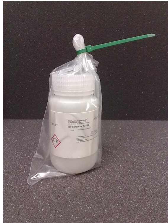
verschließen mit Kabelbinder (Schlaufe im Beutel bilden)
